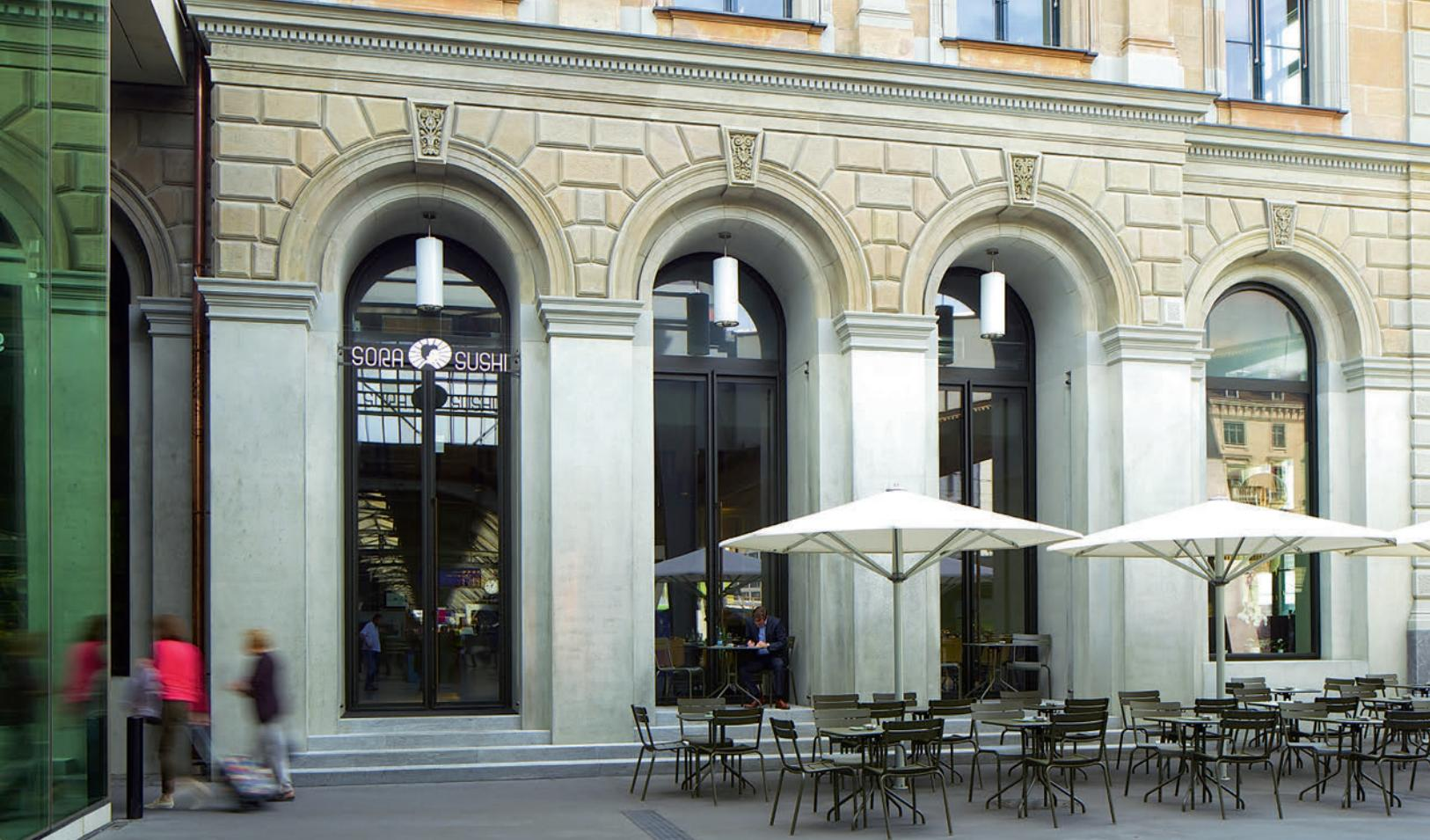
Elegant und filigran wirken die über vier Meter hohen Türelemente. Sie lassen sich mit nur 10 kg Druckkraft leicht öffnen.
